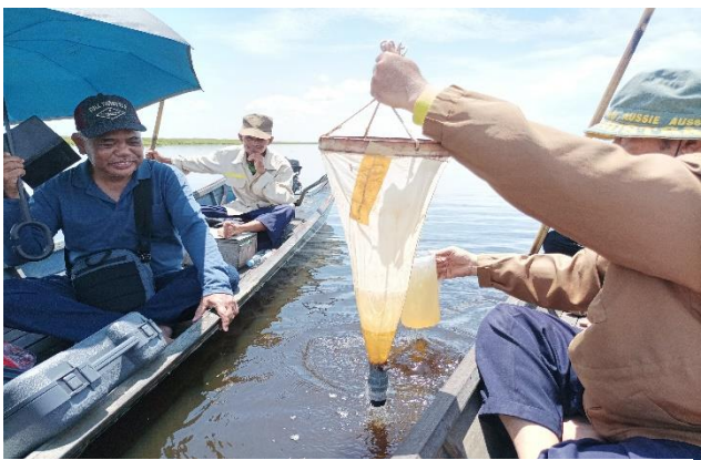
Foto 3. Pengambilan sampel plankton dengan plankton net.
