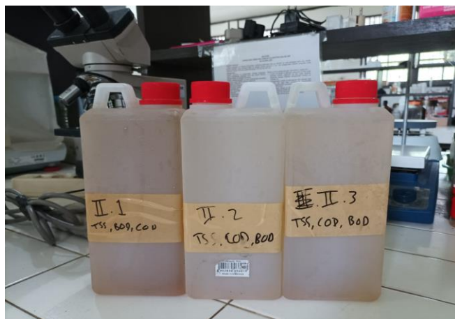
Foto 9. Sampel air untuk analisa beberapa parameter secara eks situ di laboratorium
