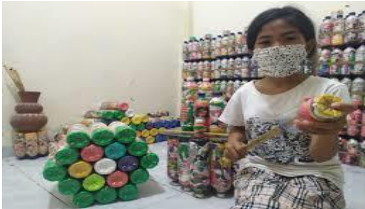
Gambar 5. 9 Memadatkan Sampah Plastik dalam Pembuatan Ecobrick
