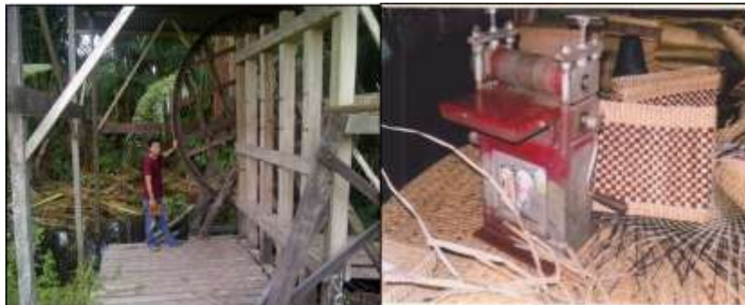
Alat Penumbuk Purun (Kiri), Alat Pemipih Enceng Gondok (Kanan)
