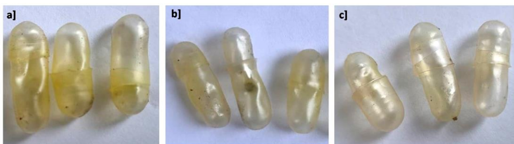
Gambar 2. Penampakan fisik cangkang kapsul keras berdasarkan suhu operasi, a) 50 °C, b) 70 °C, dan c) 100 °C.
