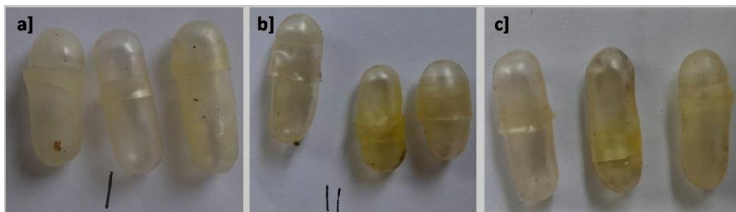
Gambar 1. Penampakan fisik cangkang kapsul keras berdasarkan rasio perbandingan pati singkong terhadap gel kembang sepatu, a) 8:1, b) 7:2, dan c) 6:3.
