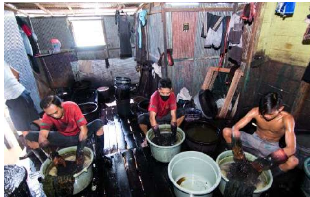
Gambar 10.4 Proses Pewarnaan Kain Sasirangan
