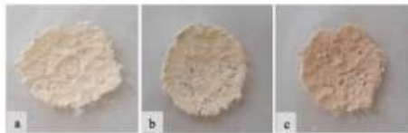
Gambar 3. Foto mikrokrystal selulosa dengan konsentrasi HCl 1,5 N (a), 2,5 N (b) dan 3,5 N (c)
