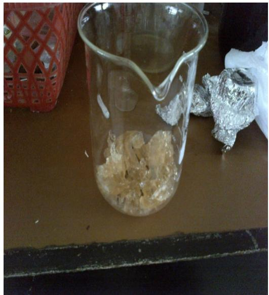
Gambar 12. Hasil sintesis superabsorben
