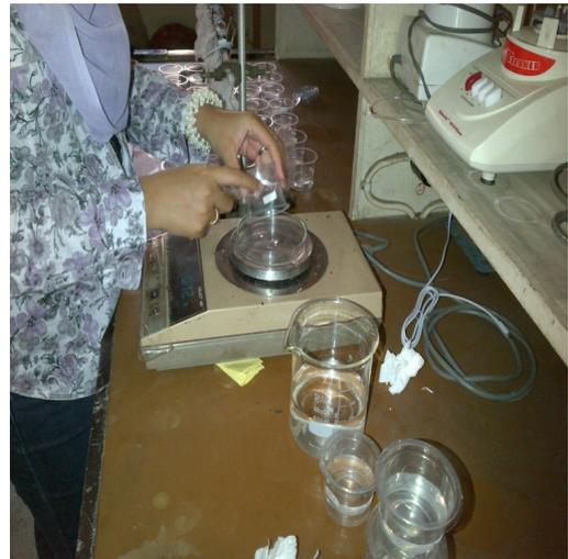
Gambar 20. Menimbang Hasil Uji Kapasitas Absorpsi
