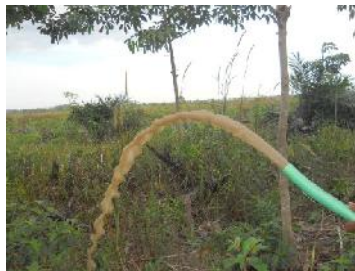
Gambar 60. Mengetes Panjang Semprotan Dan Debit
