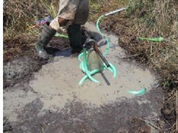
Gambar 115. Pengeboran Dengan Kedalaman 25 Meter
