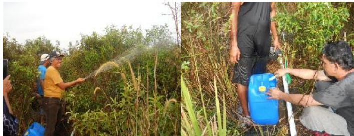
Gambar 64. Uji Semprotan Dan Uji Debit
