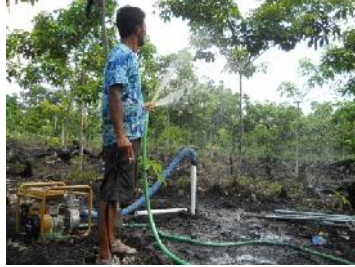
Gambar 95. Mengetes Panjang Semburan Air Dan Juga Mengukur Debit Air
