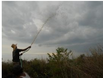
Gambar 116. Mengetes Panjang Semburan dan Debit
