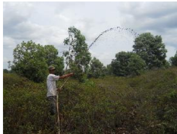
Gambar 41. Tim Pekerja Sumur Bor Uji Semprot Dan Juga Uji Debit
