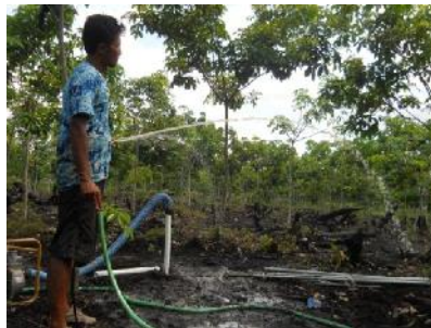
Gambar 102. Mengetes Panjang Semburan Air Dan Juga Mengukur Debit
