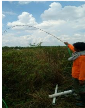
Gambar 109. Mengetes Panjang Semburan Air Dan Juga Mengukur Debit
