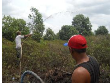
Gambar 75. Pengetesan Semprotan Air Dan Debit Air
