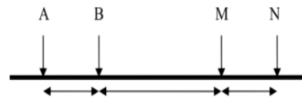
19. MBAR 1. Susunan elektroda pada konfigurasi Dipole-Dipole [9]
