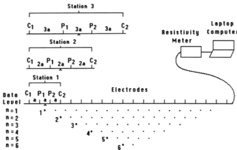
Gambar 1. Susunan Elektroda Konfigurasi
