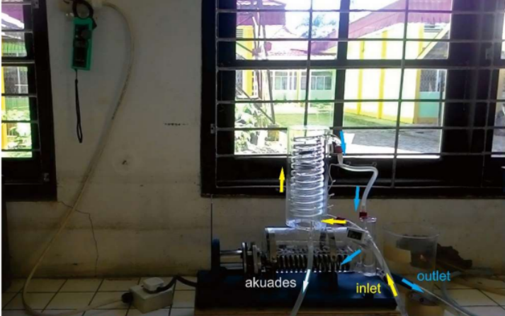
Gambar 4 Alat destilasi sebelum modifikasi
