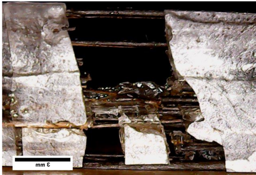
Gambar 4. Foto Mikro Patahan Spesimen Komposit Komposisi 30:70
