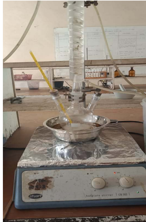
Pembuatan TEOS dengan reflux
