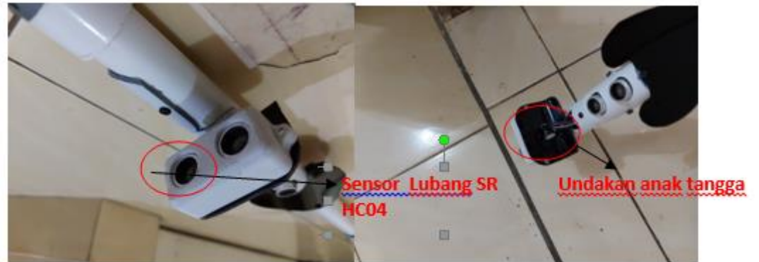
gambar 10. Sensor Pendeteksi Jalan berlubang
