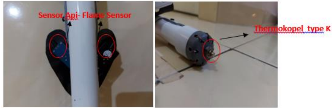
gambar 11. Sensor Pendeteksi Api
