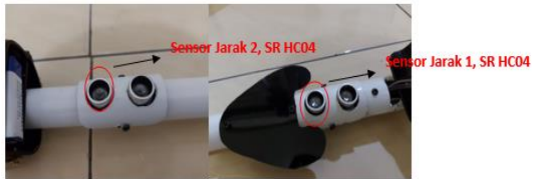
gambar 9. Penempatan Sensor Jarak Benda/Orang A dan B
