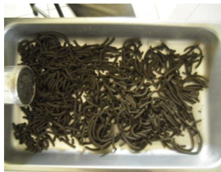
Gambar 3.3. Proses pencampuran dan penggilingan menjadi pellet
