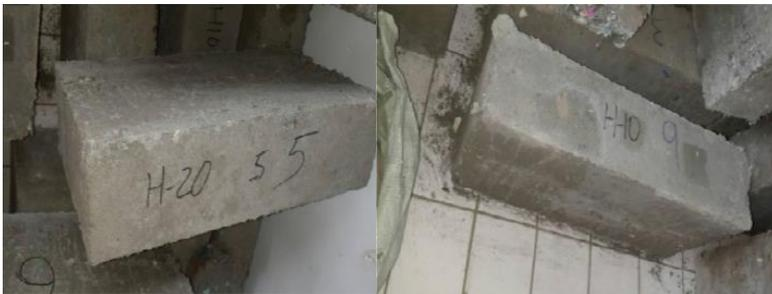
Gambar 3.3. Bata beton dengan campuran HDPE: (1) 20%; (2) 10%
