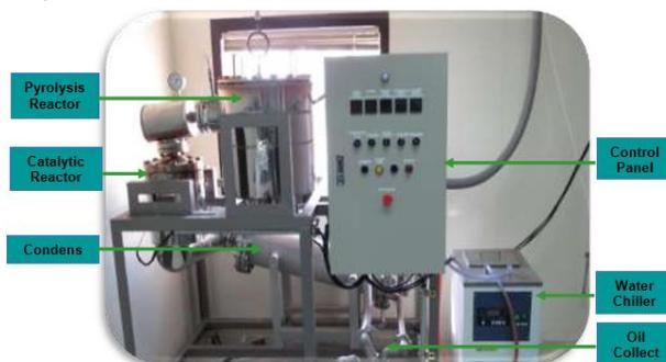
Gambar 4.3. Reaktor pirolisis skala pilot kecil (Miandad *et al.*, 2016).
