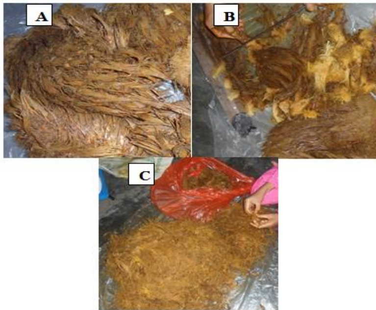
Gambar 1 Preparasi TKKS untuk bahan pembuatan arang aktif. (A) TKKS, (B) proses pemotongan TKKS, (C) proses TKKS menjadi serabut
