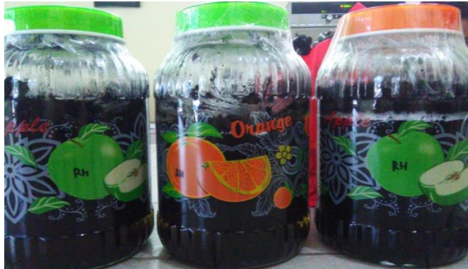
Gambar 10 Perendaman arang dengan asam fosfat 20%
