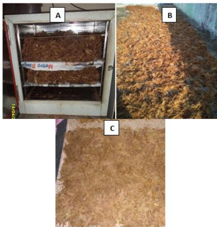
Gambar 4 Proses pengeringan serat TKKS. (A) pengeringan TKKS dengan oven; (B). Pengeringan TKKS dengan sinar matahari, (C) TKKS kering
