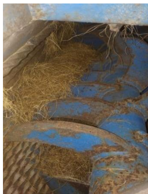
Gambar 2 Mesin pencabik serat tandan kosong kelapa sawit
